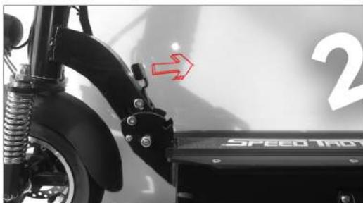
2. Mettre un pied sur le deck afin de maintenir la trottinette et tirer sur le système de verrouillage en rabattant la colonne
