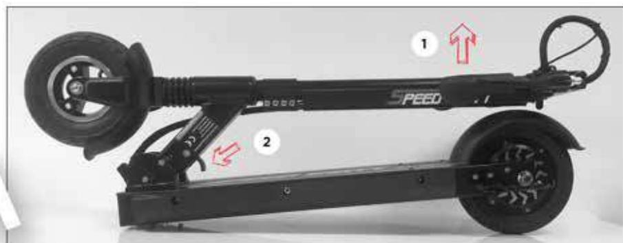
2. Appuyer en même temps sur le loquet de pliage en relevant la colonne
