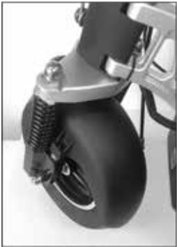
Garde boue avant
