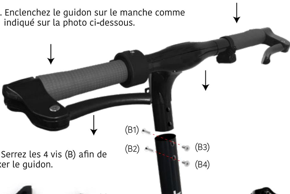
2. Serrez les 4 vis (B) afin de fixer le guidon.
