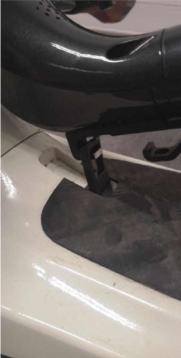
5. Accompagnez le manche juste au dessus du crochet - levez la languette metallique afin de la mettre en place sur le crochet. Vous devez sentir une certaine résistance, il faut appuyer sur le manche pour arriver a la hauteur du crochet et pouvoir l'enclencher, ceci afin d'éviter tout décrochement une fois en place.
