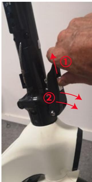
2. Poussez vers le haut le loquet de sécurité et tirez le mécanisme vers l'extérieur
