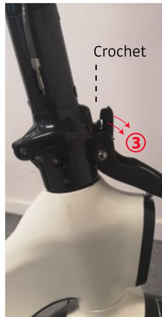
3. Le mécanisme doit être tiré vers le bas afin de débloquer le crochet. Maintenez la colonne avec l'autre main afin de retenir le manche.
