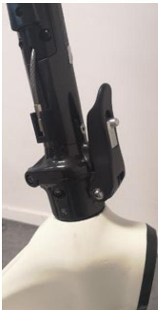
1. Mécanisme de pliage en position fermée.
