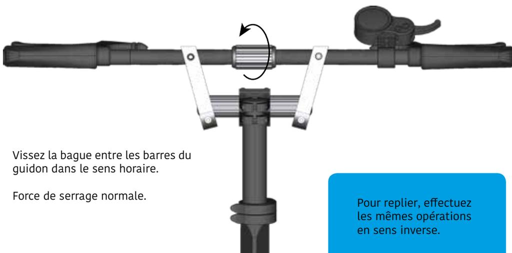
Vissez la bague entre les barres du guidon dans le sens horaire.
