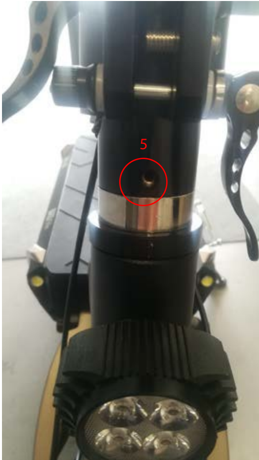
(5) Emplacement pour l'axe de sécurité en position de blocage sur la colonne
