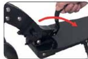
2. Appuyez fermement sur les deux côtés du bouton de pliage vers l'intérieur, avec la main droite, tandis que la main gauche accompagne la colonne de direction.
