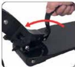
3. Desserrez la pince de déverrouillage rapide et régler la barre en T à votre hauteur. Ensuite, verrouillez la pince de déverrouillage rapide.
