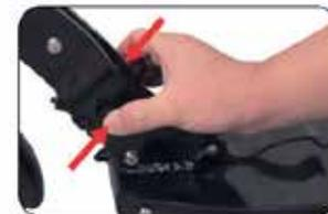
3. Finissez l'opération de pliage en basculant la colonne de direction jusqu'au garde-boue arrière.
