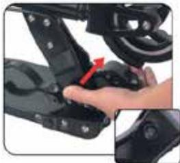
2. Tirez vers le haut et verrouillez le levier de pliage. Veillez à régler le levier de pliage de manière à ce qu'il se ferme hermétiquement et soit solidement en place.
